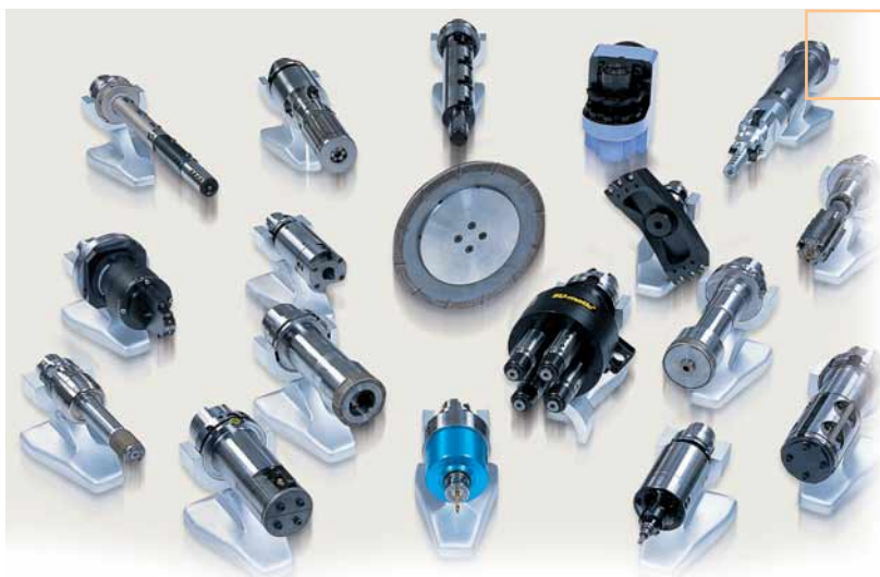
Utensili 'Smart Tool' impiegati sui centri di lavoro a1.
