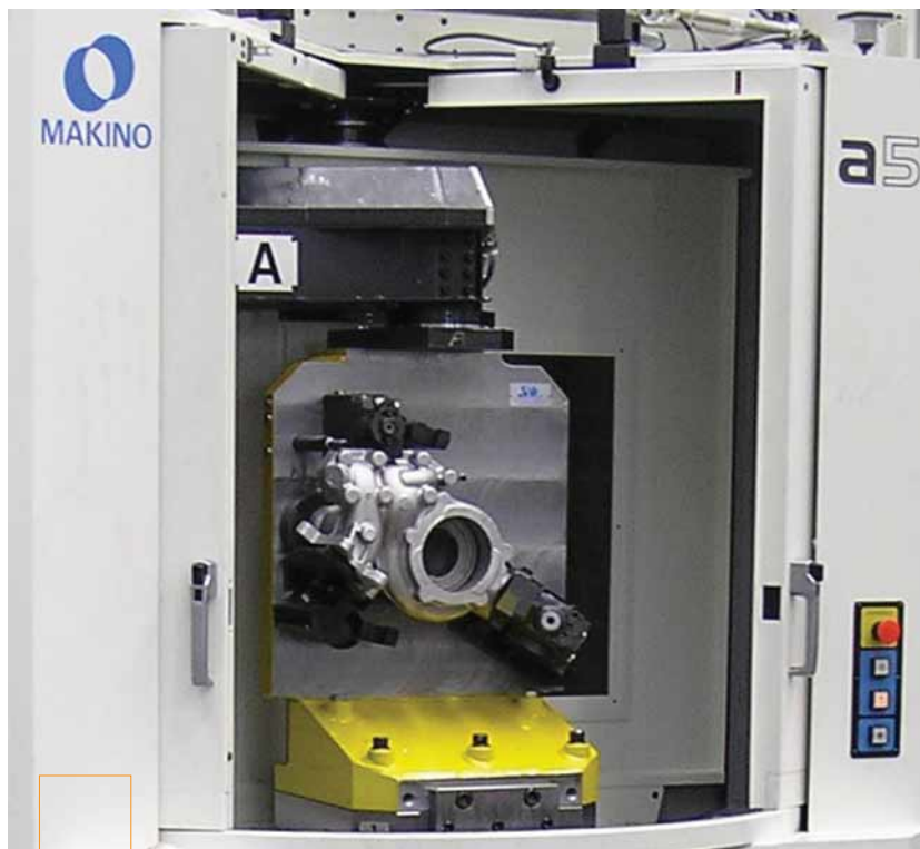
Lavorazione di un corpo pompa d'alluminio per applicazioni automobilistiche, con un centro di lavoro a51.
