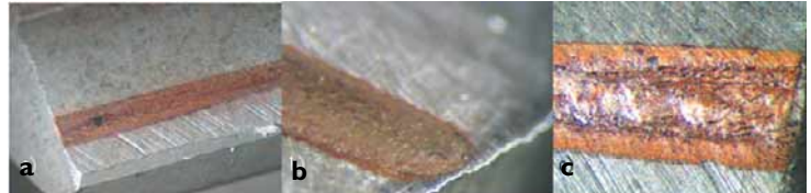
6. Immagini della zona di contatto rullo-fianco del dente dopo le prove per le ruote cementate.
