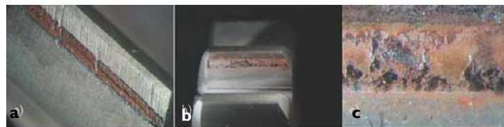
7. Immagini della zona di contatto rullo-fianco del dente dopo le prove per le ruote rivestite con CrN.
