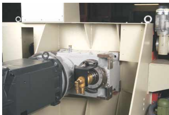
Un riduttore ad assi paralleli di Bonfiglioli con le opzioni del sistema modulare sviluppa la forza necessaria.
