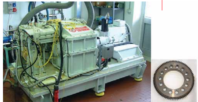
5. Banco prova ingranaggi a ricircolo di potenza e dentature campione utilizzate.
