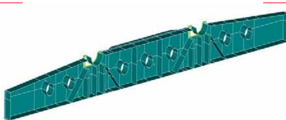
11. Modello geometrico della trave per il calcolo FEM.
