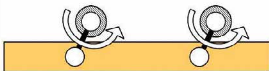
4. Schema del meccanismo di movimentazione della lama.
