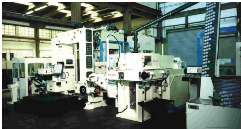
Pressa per estrusione Balconi serie KE da 400 tonnellate.
