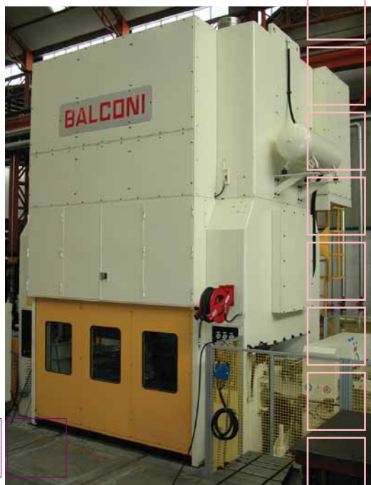
Pressa automatica Balconi con sistema di rallentamento Balconi Esadrive serie 2DMRF-G da 630 tonnellate.
