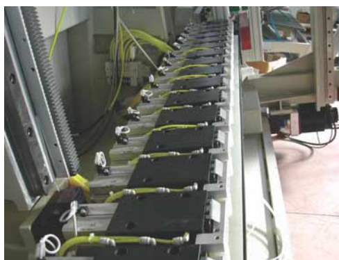
Cilindri compatti Smc per la movimentazione del supporto del pannello di legno.
