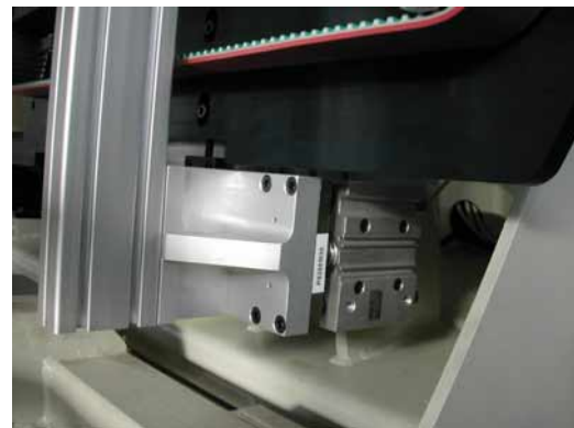
Cilindri compatti Smc per la movimentazione del supporto del pannello di legno.
