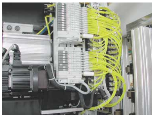
Isole di valvole per il comando degli attuatori.
