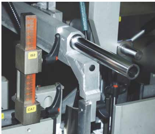
Le lamine igus hanno permesso di eliminare la lubrificazione e di aumentare la velocità in una macchina astucciatrice
