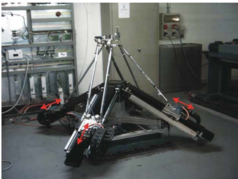
1. La struttura parallela a 3 o 4 gradi di libertà (posizione capovolta provvisoria).
