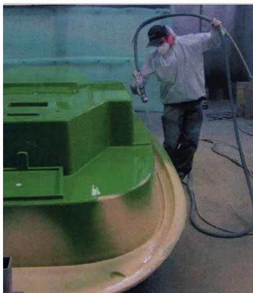
Neogel Eco, di Dsm, fa parte della recente generazione di gelcoat. Esso ha un basso contenuto di stirene.
