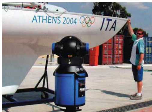
Per la misurazione mobile di componenti di grandi dimensioni il laser tracker Cam2, proposto da Cam2.
