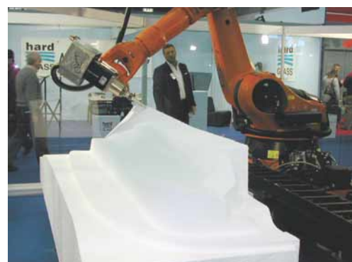
L'isola robotizzata, proposta da Qdesign, per la fresatura dello scafo di un'imbarcazione.
