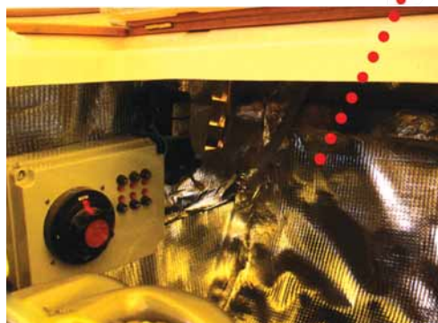
3M Thinsulate Acoustic Insulating Panel, è un materiale composito realizzato dall'unione di tre differenti componenti.
