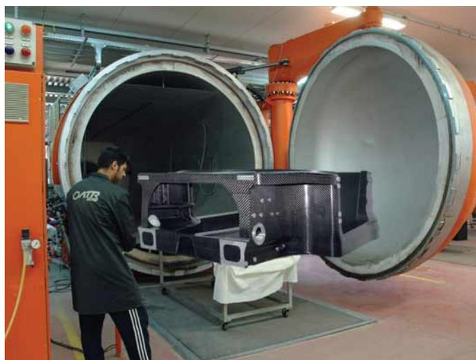
Utilizzando materiale composito è possibile ridurre il peso del 35% rispetto a un progetto in alluminio.
