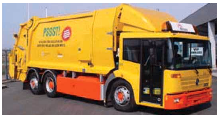
2. Veicolo elettrico ibrido con impianti idraulici ad acqua.
