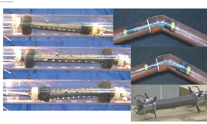
3. Robot per l'ispezione dei condotti.
