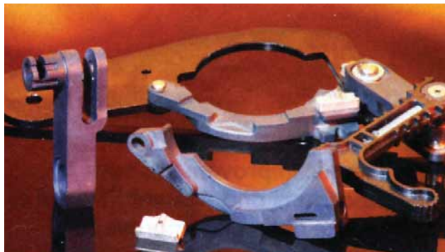
7. Gruppo inferiore utilizzato in un macchinario per l'industria tipografica.
