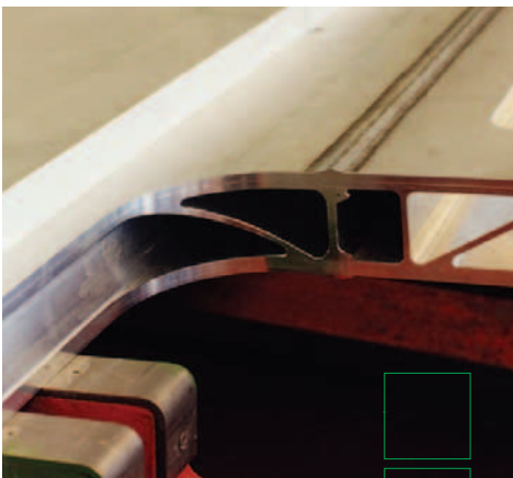
Figura 8. Cordone di precisione senza incisioni marginali e con buona penetrazione su un elemento di finestra finito, prima dello spianamento del cordone (foto: Cloos, Haiger).
