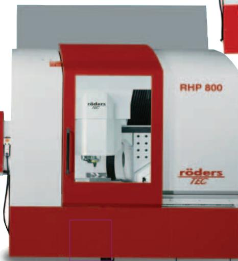
Il modello più sofisticato di macchina utensile proposto da Röders è talmente preciso da consentire sia operazioni di fresatura ad alta velocità, sia lavorazioni di rettifica a coordinate.
