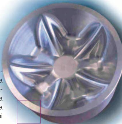
**Un esempio di stampo per la produzione di bottiglie in PET (parte inferiore) realizzato da Röders con le sue macchine.**
