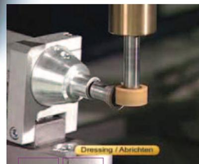
**Particolare dell'accessorio di ravvivatura delle mole di rettifica integrabile nei modelli della famiglia RHP.**
