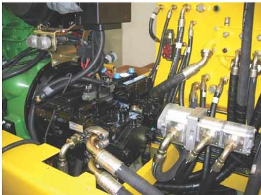
Sono visibili le due pompe a pistoni (in nero), la più grande per la trazione e l'altra per la fresa decespugliatrice. Le pompe ingranaggi azionano i servizi. Da notare la pulizia e l'accuratezza del montaggio del sistema.
