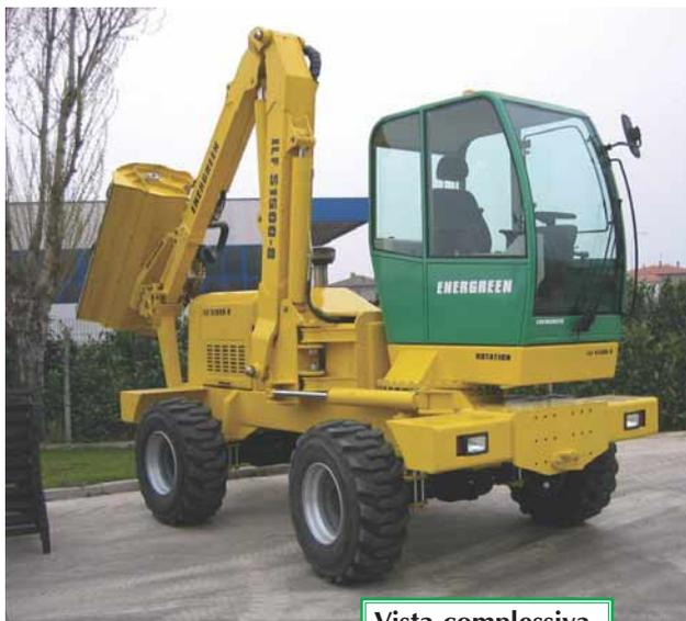
**Vista complessiva della macchina, in configurazione da trasferimento, senza accessori.**
