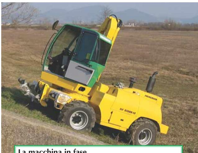
**La macchina in fase di lavoro può superare salite ripide a pieno carico, senza sovraccaricare il motore termico e regolando automaticamente la velocità di avanzamento in maniera ottimale.**
