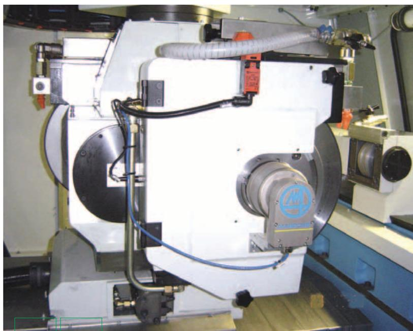
La testa porta mola ha due elettromandri paralleli con potenza di 11 kW, nella fase di sgrossatura, e 7,5 kW nella fase di finitura.
