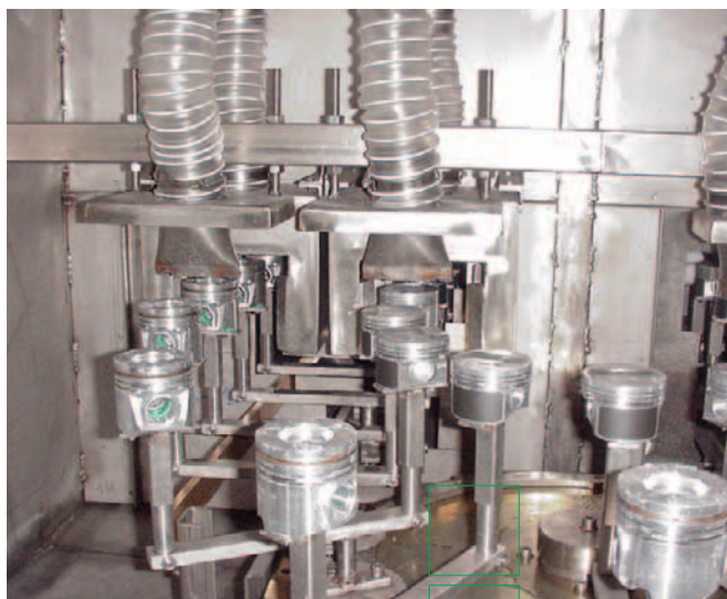
Zona di soffiatura con lame indirizzate.
