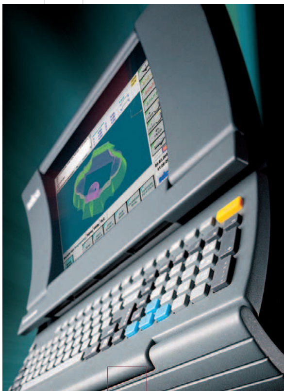
I controlli numerici Selca S4000 sfruttano due processori, uno per la gestione dell'interfaccia operatore e uno per il controllo della macchina utensile.
