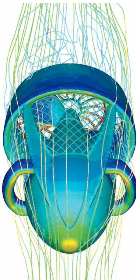
**Analisi con passaggio del fluido sia interno sia esterno.**
