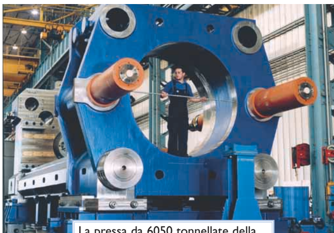
La pressa da 6050 tonnellate della Breda Danieli installata in Metra nel 2002.
