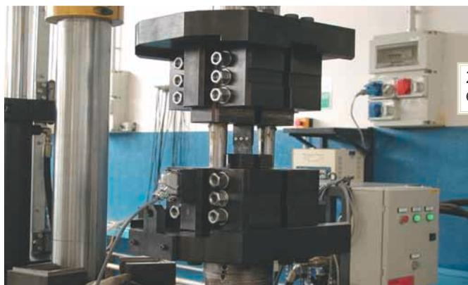
2. Sistema di afferraggio utilizzato e installazione del componente.
