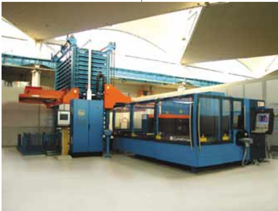
TowerServer: sistema di automazione compatto e flessibile per la produzione non presidiata.
