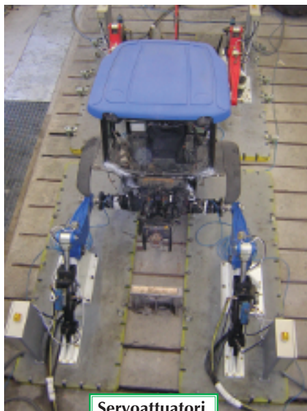
Servoattuatori idraulici Moog utilizzati nel laboratorio CNH.
