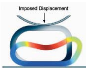
Analisi non lineare per grandi spostamenti, contatto e materiale iperelastico.
