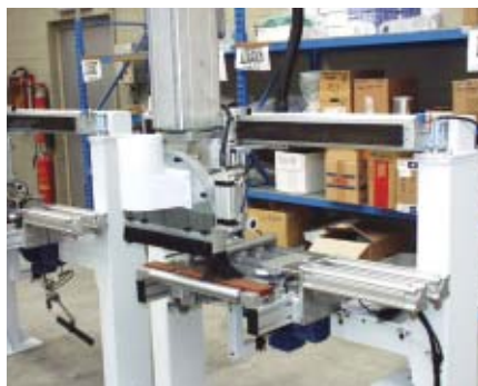
Gruppo di troncatura automatica con verifica delle dimensioni della sezione del pezzo.
