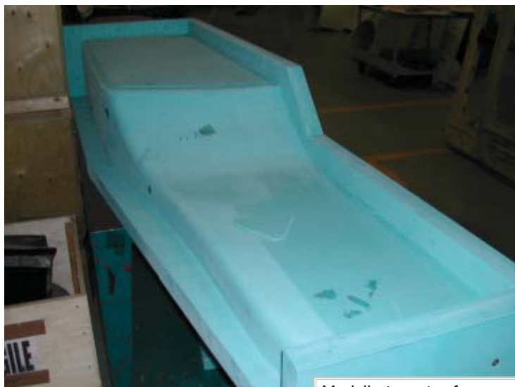
Modello in resina fresato con una macchina utensile a 5 assi. Progetto e percorso utensile sono stati creati con Powershape e Powermill di Delcam.
