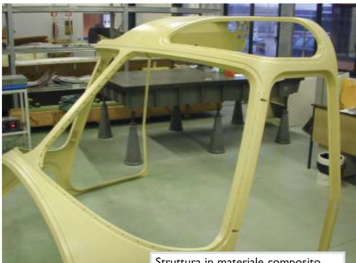
Struttura in materiale composito della carenatura di un elicottero; il peso è di pochi chilogrammi.
