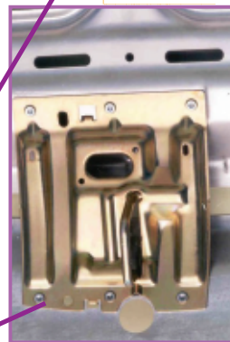
Figura 6. Rivettatura rinforzata in acciaio su cofano in Al.
