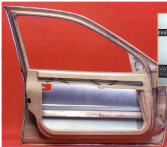
Figura 2. Differenti geometrie del cordone e quantità di adesivo erogato (fonte SCA), porta multimateriale con ossatura in magnesio e pelle in alluminio incollata, sviluppata nell'ambito del progetto Magdoor.
