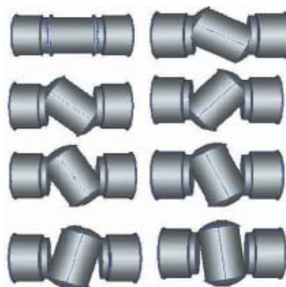
Domini fluidi in funzione della rotazione della sfera.
