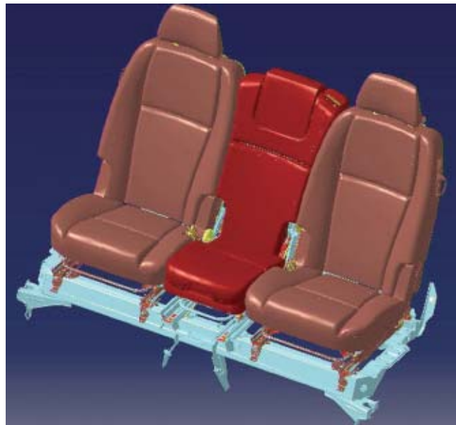
Il telaio di supporto della fila centrale di sedili della Volvo XC90 è realizzato con acciaio altoresistenziale di SSAB Tunnplat.
