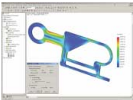
Analisi statica lineare. Andamento dello stress secondo von Mises mostra un massimo pari a 112 MPa contro un limite di snervamento del materiale pari a 55 MPa. Questa condizione indica che è necessario risolvere il problema con un approccio non lineare.
