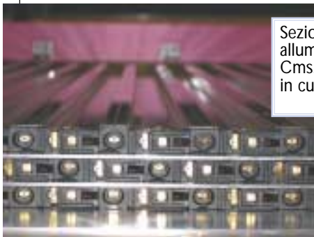
Camera formata da pannelli sandwich in alluminio alternati ad una struttura alveolare, anch'essa in alluminio. Ogni pannello è il risultato dell'accoppiamento di fogli di lamiera (circa 2m x 3m) incollati ad uno strato di profilati.
