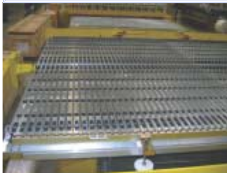
Pannello sandwich alternato a struttura alveolare fatta di profilati in alluminio che formano una serie di cellette in cui flusserà del gas durante l'esperimento.
