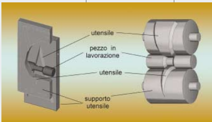
Figura 3. Laminazione eseguita con due differenti tipi di utensili.
