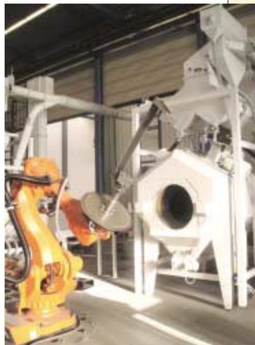
Figura 4 La granigliatrice Roboblaster RROB 350/1200.
