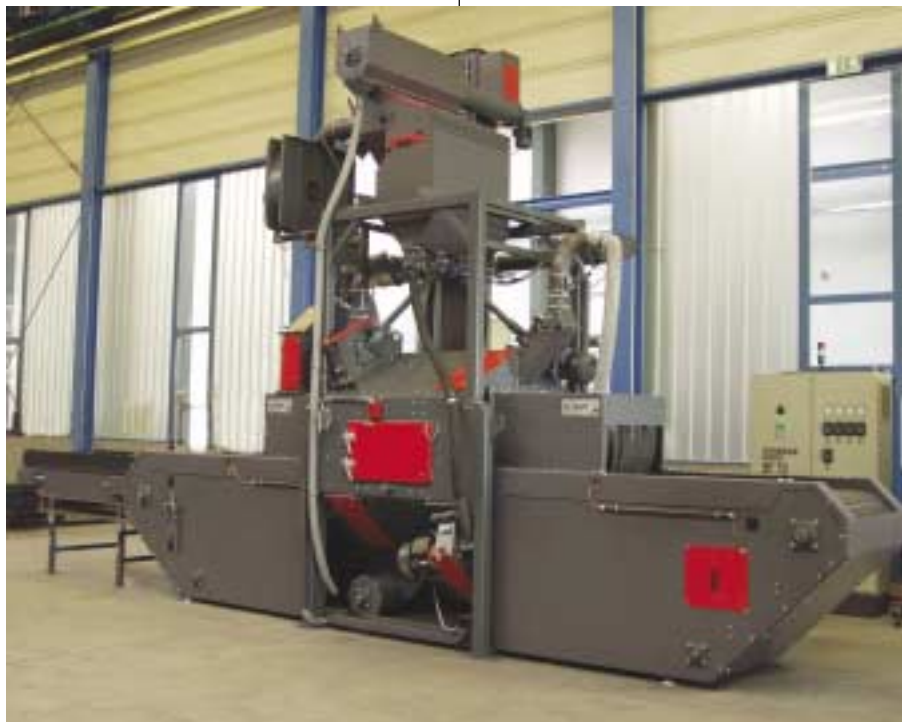
Figura 5 La granigliatrice RDGE con tappeto a maglie metalliche di Rösler Italiana è perfettamente adatta al trattamento completo sia di componenti piatti, sia di pezzi molto complessi, all'interno di un sistema a flusso continuo.
