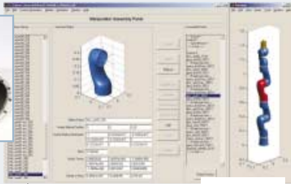
Figura 1 Robot modulare LBR3, moduli e interfaccia grafica del simulatore (cortesia DLR).
