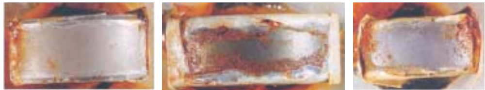
3. Campioni dopo la prova di esposizione in camera a nebbia salina; da sinistra campione protetto con Nichel +Ptf, strato di fosfatazione, fosfatazione + MoS 2 .
