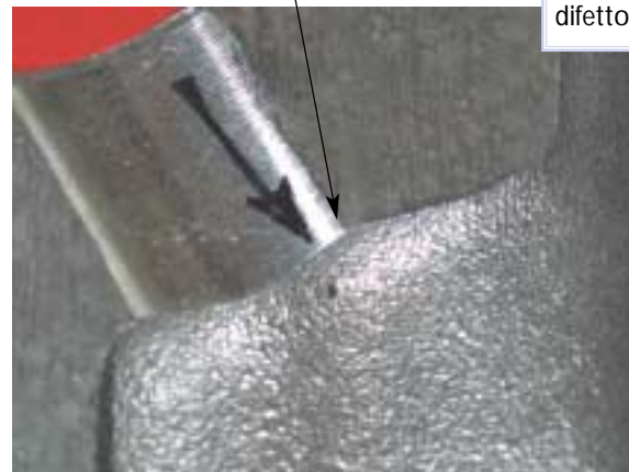
1. Particolare della sezione della testa motore e del difetto.
