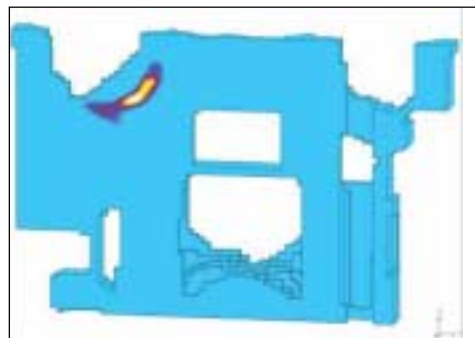
4. Immagine della sezione a rischio di porosità del processo reale e criterio di porosity.
