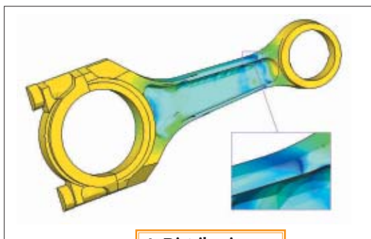
4. Distribuzione dello sforzo di compressione e ingrandimento della zona di maggior intaglio.
