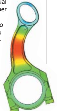
10. Instabilità nel piano del moto, accentuato di 45 volte.
