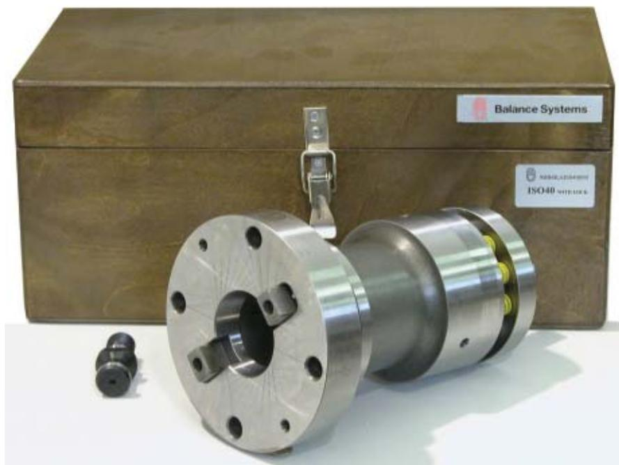
BB4000 dispone di adattatori intercambiabili che consentono l'equilibratura di diverse tipologie di portautensili in relazione all'attacco ISO o HSK.
