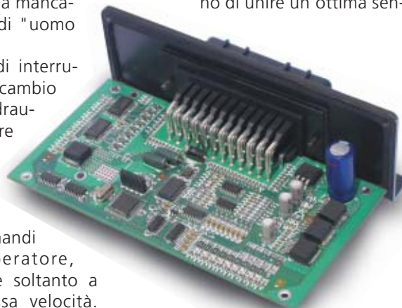
Scheda elettronica digitale a microprocessore della serie Glr per gestione della trasmissione idrostatica.
