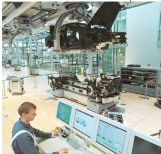
Logistica raffinata: lungo piste elettriche sospese le carrozzerie vengono trasportate alle singole stazioni di lavorazione in cestelli a guida automatica, che contengono tutti i componenti necessari per il veicolo. Si eliminano percorsi inutili.
