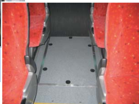
Pannelli di accesso del corridoio nel minibus della Noge, dove la chiusura della Southco è usata assicurando una tenuta sicura anche in presenza di vibrazioni.
