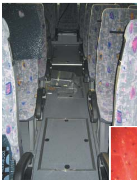
Pannelli di accesso del corridoio nel minibus della Noge, dove la chiusura della Southco è usata assicurando una tenuta sicura anche in presenza di vibrazioni.
