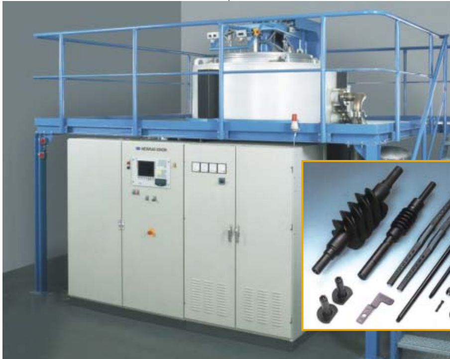
Ionit Ox® sistema Mipox e componenti trattati con Ionit Ox®.
