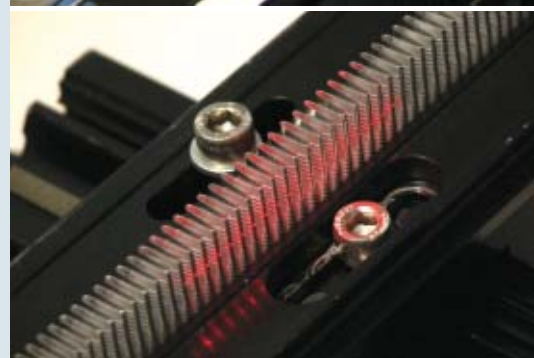
Prototipo realizzato da ImagingLab e dettaglio dell'illuminazione laser sulle alette in movimento.
