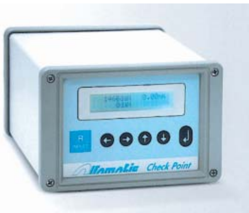
Sistema Check Point. Si tratta di un controllo di processo di assemblaggio. Esso controlla la curva forza-spostamento in dieci punti.
