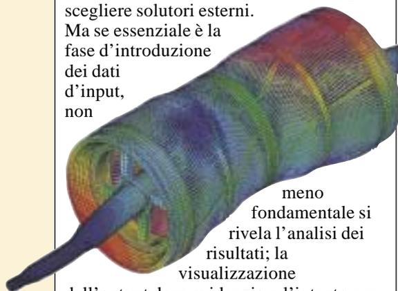
**Modo di vibrare del rotore di una turbomacchina corrispondente ad una velocità critica ottenuta attraverso un'analisi con Samcef Rotor. (Fonte: Ecutec S.L./Barcellona)**
