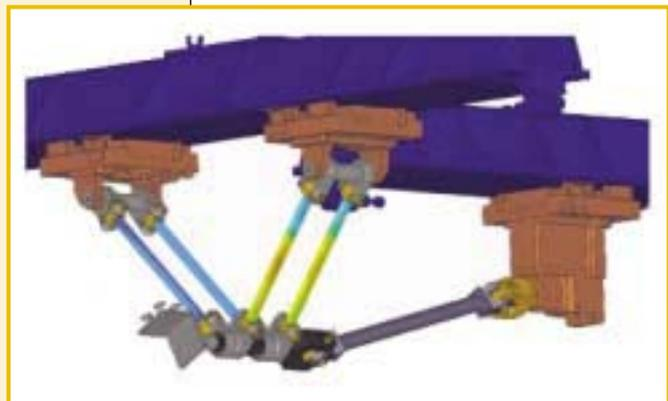
**Analisi dinamica del movimento di una macchina utensile a cinematica parallela (PKM), denominata 'Morpheus', realizzata da ITIA-CNR. Il modello, prodotto con Samcef Mecano, è composto da parti rigide e da parti flessibili modellate a elementi finiti, sulle quali sono evidenziate le mappe di sforzi che variano dinamicamente durante il movimento.**
