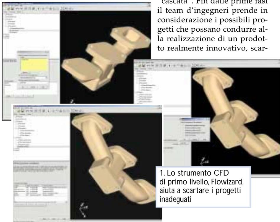
1. Lo strumento CFD di primo livello, Flowizard, aiuta a scartare i progetti inadeguati
