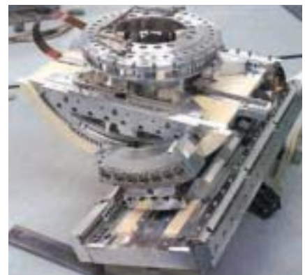
10. Meccanismo di movimentazione di un piano a sette gradi di libertà per la analisi di wafer da 300 mm mediante microscopio elettronico.
