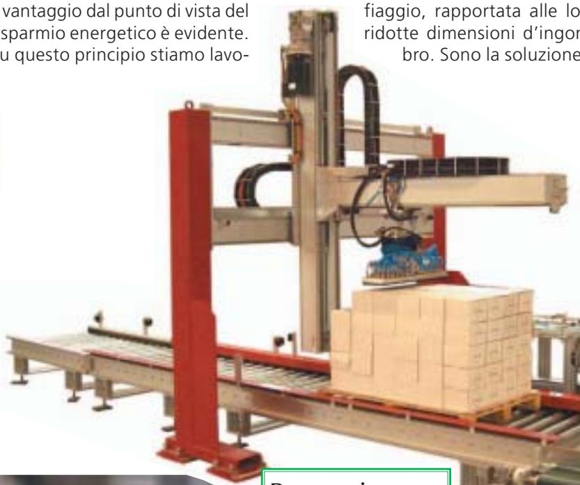
**Due esempi di applicazione del sistema Octopus su robot a portale e antropomorfo per la movimentazione di scatole di cartone.**
