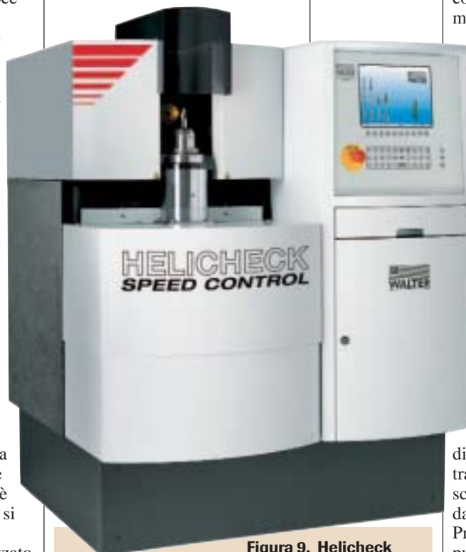
Figura 9. Helicheck Speed Control, macchina per misurare le tolleranze standard, ha il rilevamento dei punti di riferimento da 3 prospettive utensili diverse.
